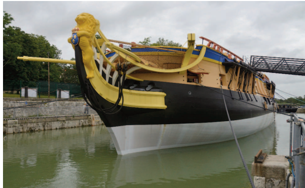
2 - 2012 - après 15 années de chantier, la coque est terminée, étanchée et peinte. L'eau de la Charente peut enfin pénétrer dans la forme de radoub.
