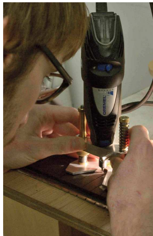
Avec un défonceuse miniature, Pierre prépare une touche de guitare pour recevoir les repères en nacre (Guitare et Création, Bordeaux).
